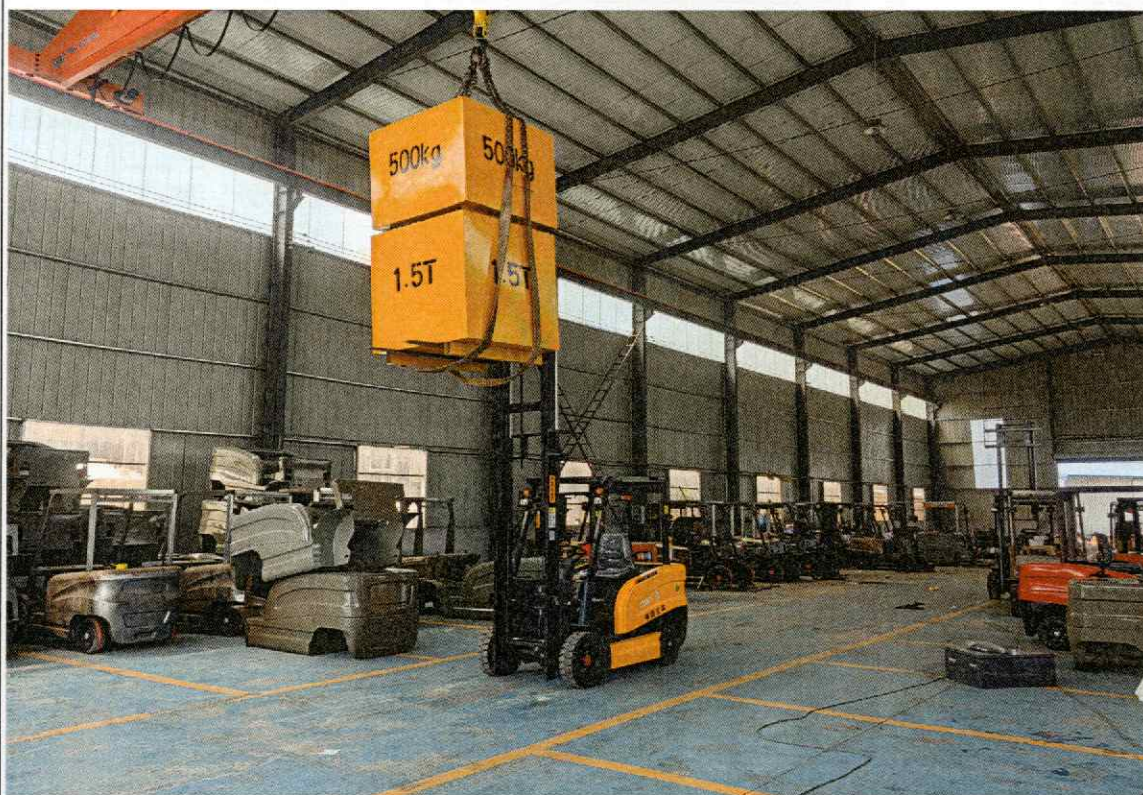
照片3主要受力结构件强度试验工况
